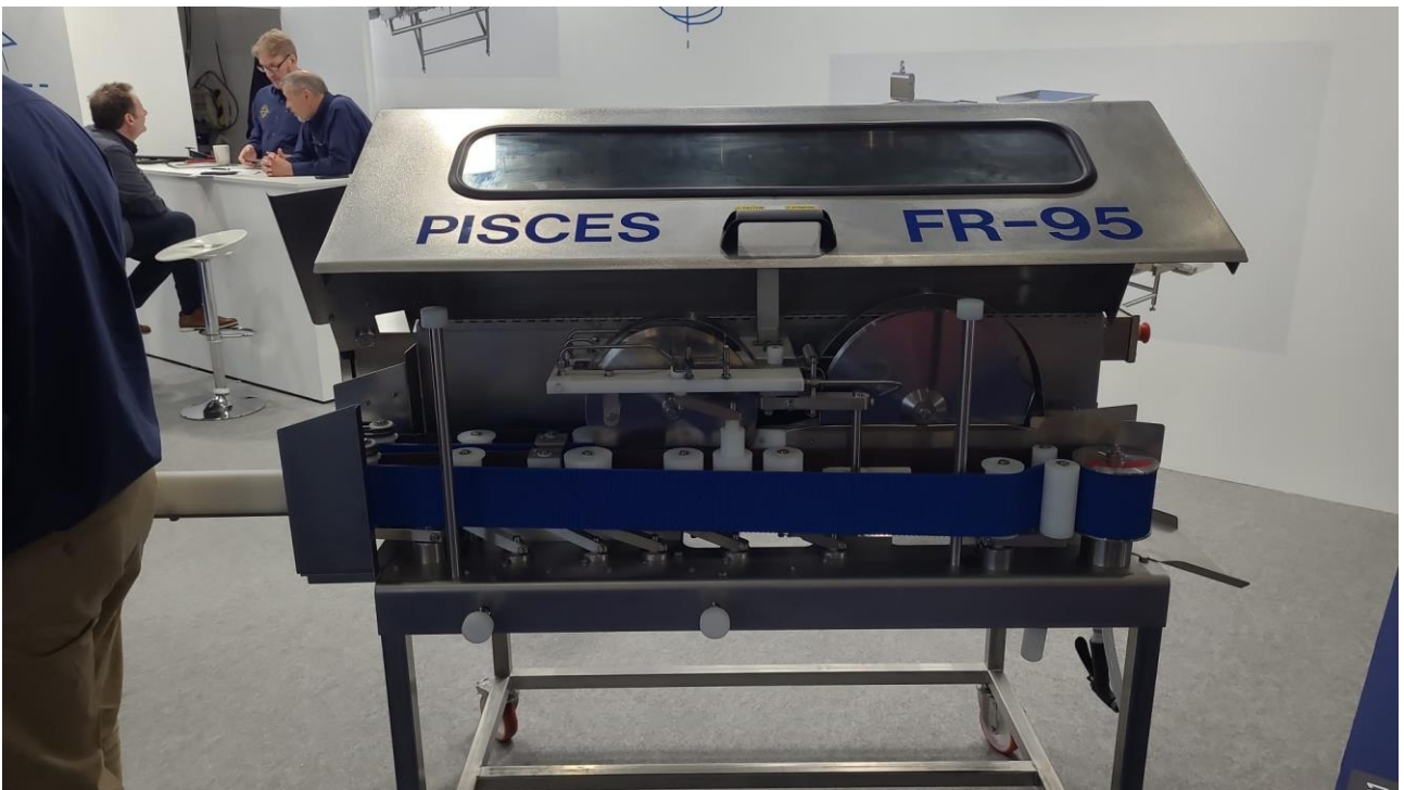
kuva 2 Pisces valmistaa muun muassa fileerauskoneita. Kuvassa oleva kone soveltuu esimerkiksi ahvenen filerointiin.
