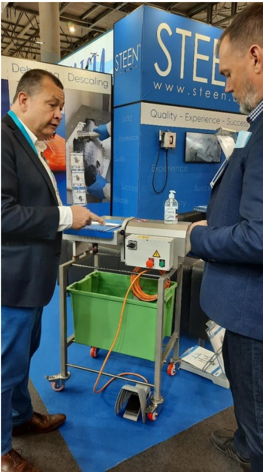
kuva 3 Kiinalainen nahoituskone pienemmille kalaerille.
